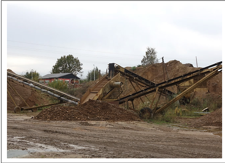
Siebanlage mit Elektroantrieb (Schallquelle 3)
